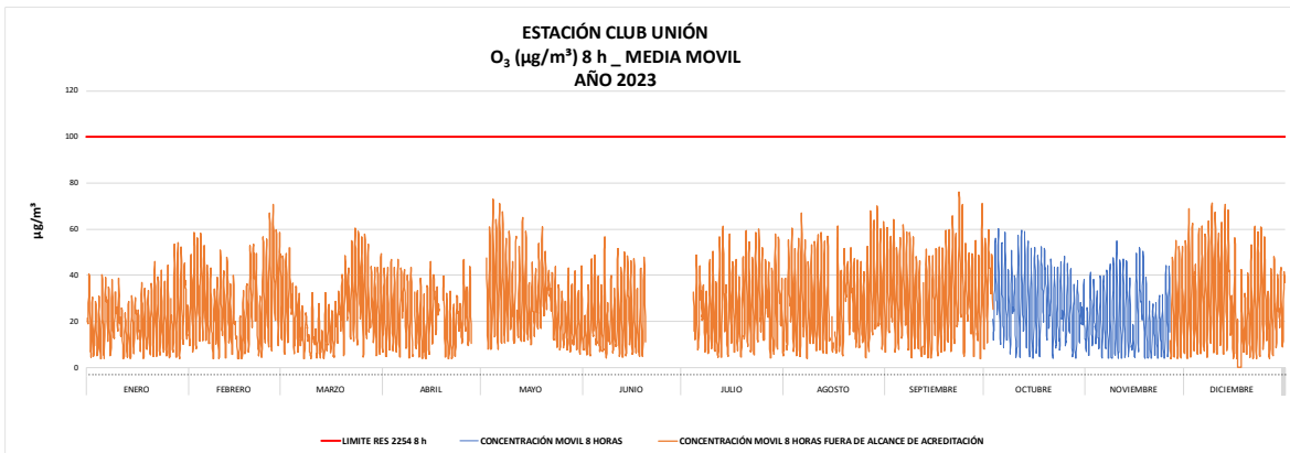
Figura 17 Distribución temporal de la concentración de O_3 estación Club Unión
